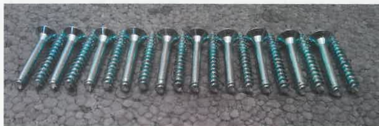
▲ Obr. 1 Vrutky po zkoušce únosnosti v tahu
