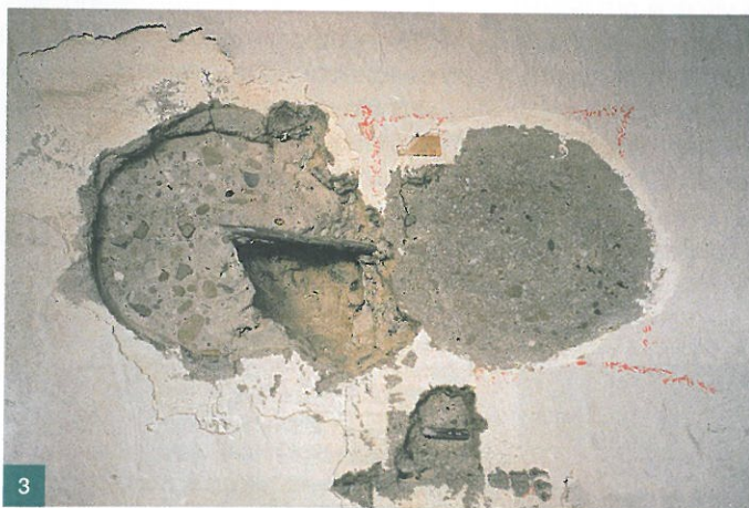
3 U starších konstrukcí je nutné odstranit omítku (vpravo) a vybrousit povrch, aby byla vidět struktura betonu (vlevo) 4 a) Tři způsoby úpravy zkušební plochy; A – neobroušený, B – obroušený, ale zkarbonatovaný, C – obroušený, nekarbonatovaný, b) aplikace tvrdoměrné metody – zkoušení Schmidtem N na správně upravené ploše C 5 Kovadlina EURO pro kalibraci tvrdoměrů systému Schmidt ■ 3 In older structures it is necessary to remove the plaster first (right) and grind the surface smooth to reveal the structure of the concrete (left) 4 a) Three ways of preparing the testing surface; A – unground, B – smooth, but carbonated, C – smooth, not carbonated, b) rebound hammer test – use of the Schmidt N on a correctly prepared surface (C) 5 EURO test anvil for calibrating the Schmidt hammers
