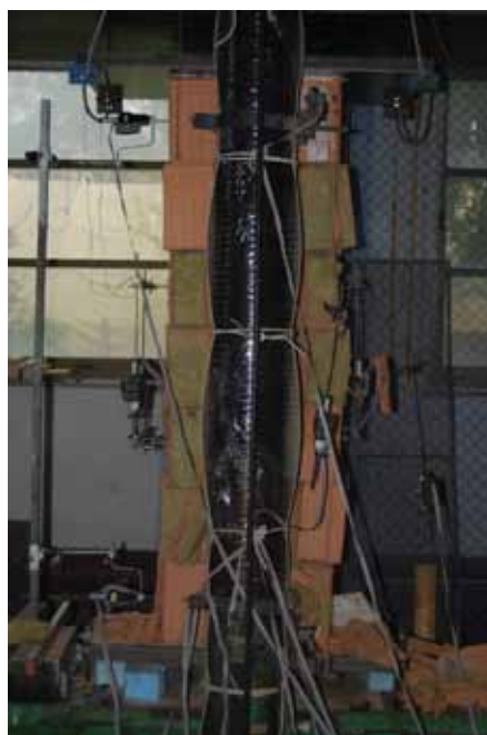
▲ Obr. 11b. Střední pilíře – fotodokumentace ze zkoušek; typy porušení – střední pilíř v lisu po provedené zkoušce
