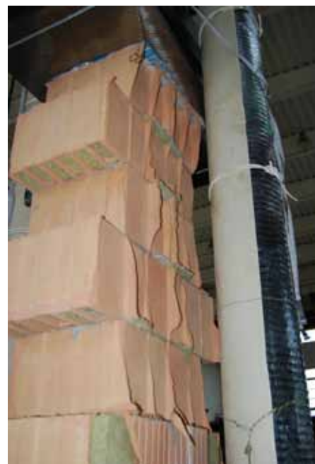
▲ Obr. 8c. Vysoké pilíře – fotodokumentace ze zkoušek; typy porušení: porušení ve zhlaví [e = 1/3 h]
