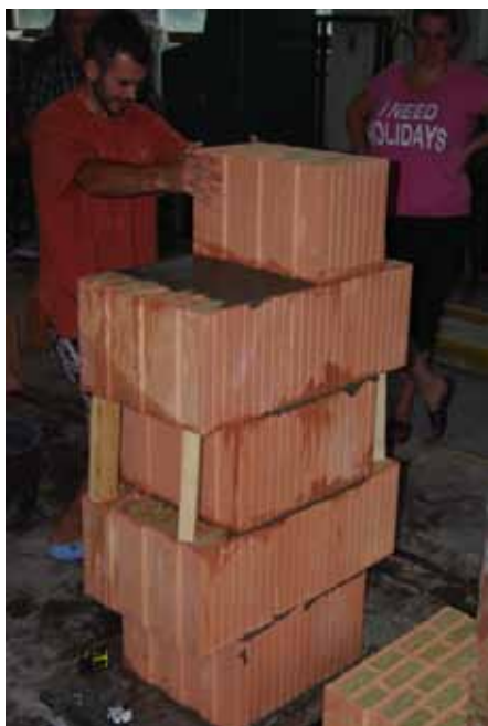
▲ Obr. 8a. Vysoké pilíře – fotodokumentace ze zkoušek; typy porušení: zdění vysokých pilířů
