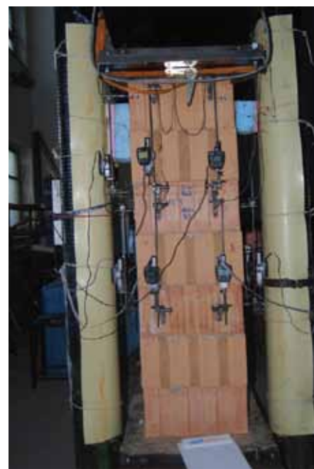
▲ Obr. 11c. Střední pilíře – fotodokumentace ze zkoušek; typy porušení – osazení středního pilíře do lisu, vystrojení měřidly
