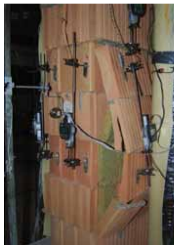
▲ Obr. 5a. Středně vysoké pilíře s aplikací výstřednosti zatížení v obou hlavních směrech: porušení středního pilíře s oboustrannou excentricitou – vystrojení deformetry
