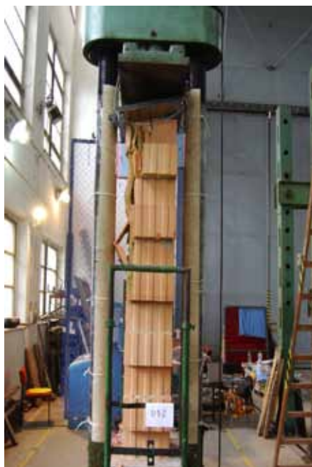
▲ Obr. 8b. Vysoké pilíře – fotodokumentace ze zkoušek; typy porušení: vysoký pilíř v lisu [e = 1/4 h]
