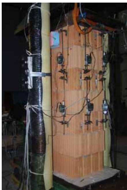
▲ Obr. 11a. Střední pilíře – fotodokumentace ze zkoušek; typy porušení – vystrojení středních pilířů v H/2 a vtačené části zhlaví
