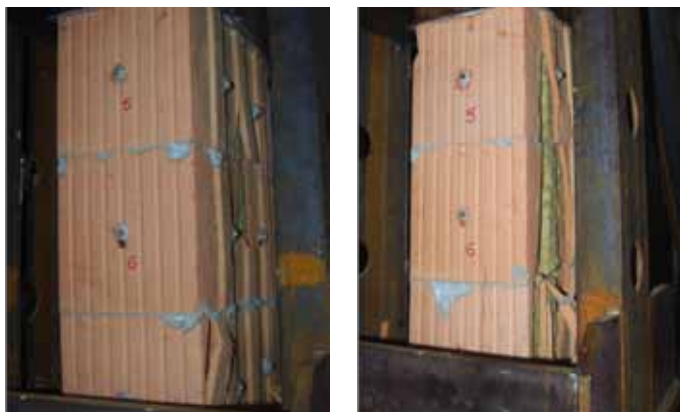
▲ Obr. 3a. Tripletly ve stendech – zkrácená dlouhodobá zkouška MV a VV (na 80 % N_d ) – při dlouhodobém mimostředném zatížení
