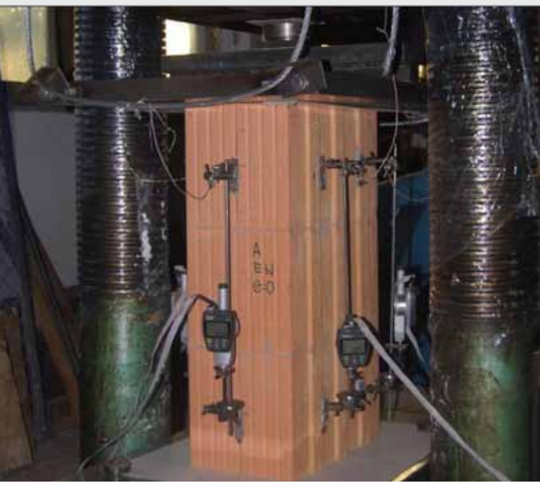
▼ Obr. 2a. Triplet s půdorysem jednoho bloku pro předběžné a ověřovací zkoušky a MM: triplety v lisu, rozmístění deformetrů
